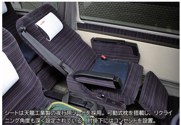
シートは天龍工業製の夜行用シートを採用。可動式枕を搭載し、リクライニング角度も深く設定されている。肘掛下にはコンセントを設置。
